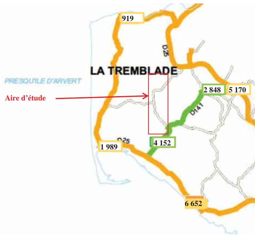
Figure 160 : Comptages routiers sur la presqu'île d'Arvert (2015-2016)
