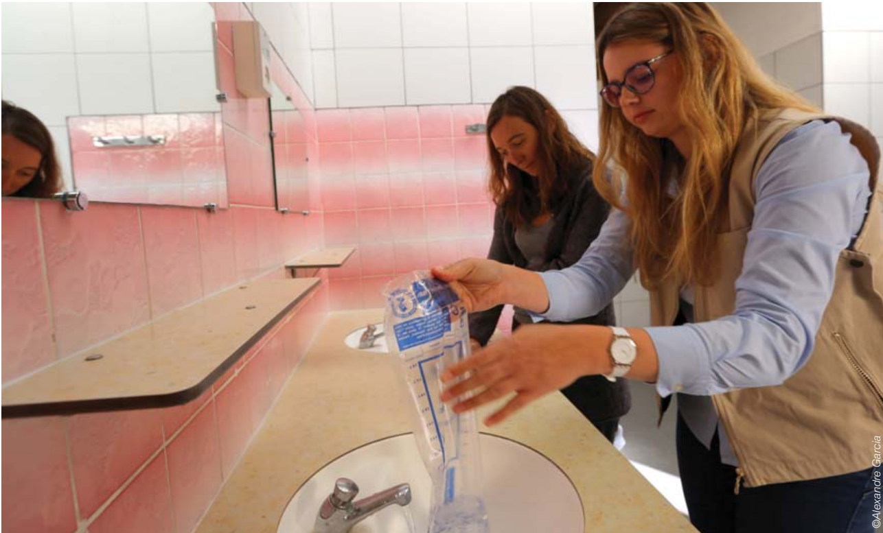
Mesure du débit des robinets et relevé des puissances des appareils électriques au camping Le Royan
